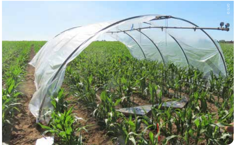
De regenvalsimulator in een proefveld met maïs. Met een spuitboom kan men hevige regen nabootsen. Via schotten in de bodem worden afstromend water en grond opgevangen in een trechter.
