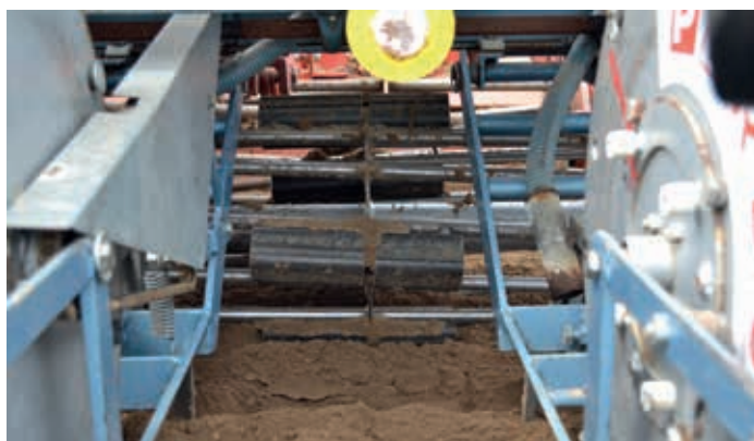
Metalen elementen op de kooirol van de plantmachine knolselder.
