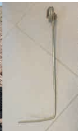
Lichtjes geplooid torsiewieders slepen over buitenste oevortjes langs de plantrij van savooikool en spruitkool en effenen de voren naast de plantrij zonder zelf een nieuwe voor te maken.
