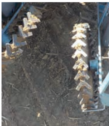
De open aandrukwielen met een visgraatpatroon, gebruikt bij knolselder, spruitkool en savooikool, liepen al snel vol met grond.
